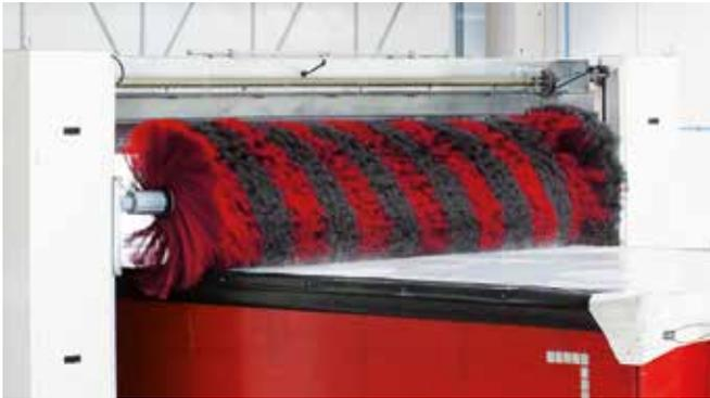
La spazzola orizzontale in polietilene ad alta densità dispone di un variatore di frequenza per addolcire il movimento di salita e discesa, oltre a **5 distinti livelli di pressione** per adattarsi ai differenti profili dei veicoli. Inoltre questo modello, grazie alla sua configurazione flessibile, permette fino a 4 scansioni "salvaostacoli" per retrovisori o parasole.
