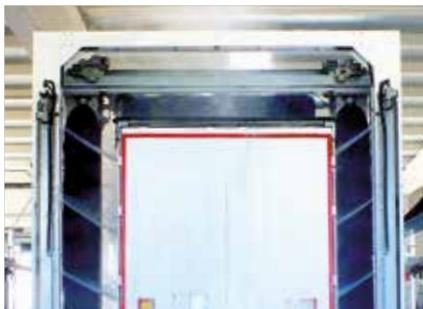
Raccomandato per lavare in profondità la parte laterale superiore dei veicoli, in particolare camion cisterna o della spazzatura o con profili speciali, e raggiungere così quelle zone in cui le spazzole verticali non possono lavare. Composto da **24 ugelli ad angolo zero** per lavare a **70 bar e 126 L/min.**, lavora con un motore di oscillazione (su-giù) e un cilindro rotante (avanti-indietro).
