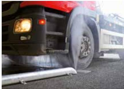
Sistema ad alta pressione per il lavaggio sottoscozza a passaggio a **70 bar** e **126 L/min**. Si installa al principio della pista di lavaggio e dispone di fotocellule di accesso per il suo azionamento automatico e di **12 ugelli rotanti ad angolo zero**. Può lavorare con lo stesso rack di pompe ad alta pressione che alimenta il portale mediante un'elettrovalvola di connessione.
