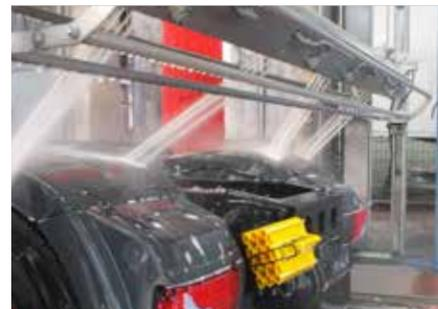
Sviluppato in particolare per il lavaggio senza spazzole delle parti frontali e superiori dei veicoli o per perfezionare i risultati di lavaggio delle flotte più esigenti. Lavora con **16 ugelli ad angolo zero a 70 bar e 126 L/min.** e con un motore di oscillazione e un altro di rotazione che permette un movimento di **180°** controllato da programma.
